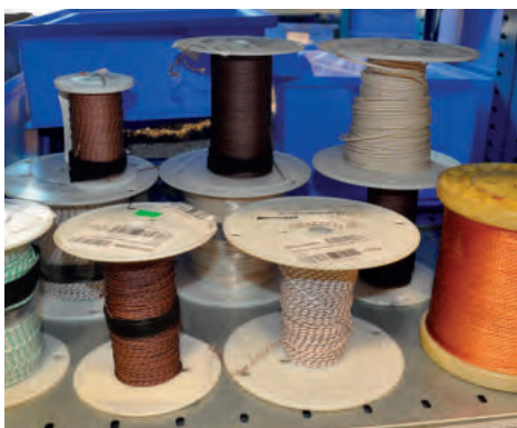
Termočláňková kompenzační vedení typu K-NiCr / Ni a typu J-Fe / Co.
