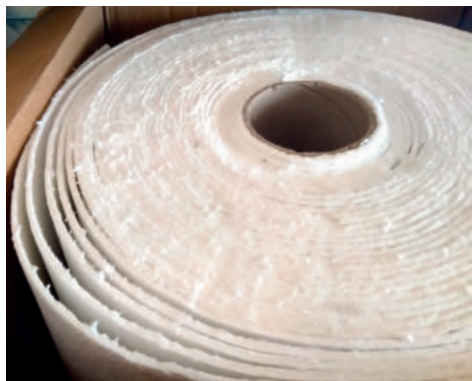
Izolační materiály na základě keramických vláken. Tloušťky 5 - 40 mm, teplotní odolnost 250 - 1200 °C.
