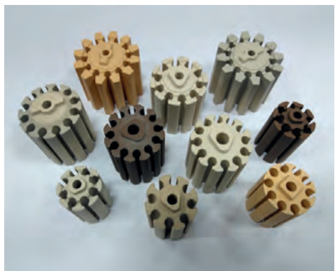
Keramické válcové nosníky s obvodovými štěrbinami pro sálání tepla z topných spirál. Materiál zpravidla Pyrostat.
