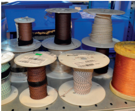
Termočlánková kompenzační vedení, typu K-NiCr / Ni, typu J-Fe / Co.
