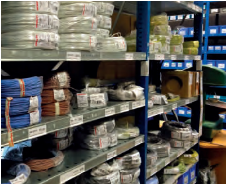
Teplotně odolné vodiče, zejména Cu / silikon do teplot 180 °C, Ni / sklotkanina až do 450 °C.
