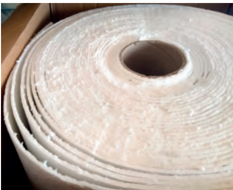
Izolační materiály na základě keramických vláken. Tloušťky 5 - 40 mm, tep. odolnost 250 - 1200 °C.
