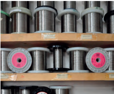
Odporové topné dráty, zejména Kanthal A, D, Nichrothal N 80, Aluchrom I, Cronix 80. Průměry od 0,02 do 6,0 mm.
