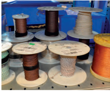
Termočlávková kompenzační vedení, typu K-NiCr / Ni, typu J-Fe / Co.
